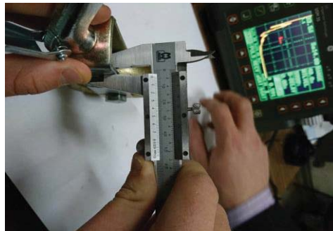
Fig 4.2 Masurare grosime scripete(4mm)
