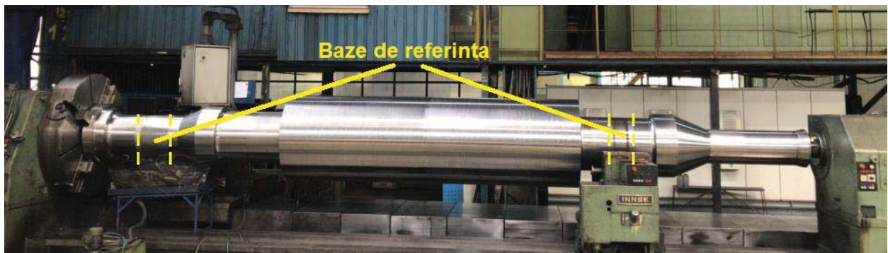
Fig. 3. Bazele de referință ale unui rotor de turbină
