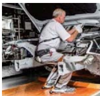
Fig. 2 Exoschelet pasiv pentru suportul picioarelor în timpul flexării genunchilor. [10]
