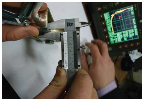
Fig 4.2 Masurare grosime scripete(4mm)
