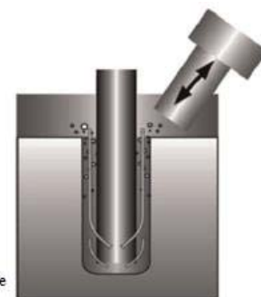
Fig. 2. b. Sonotrode ultrasonice în micro-EDM [13]
