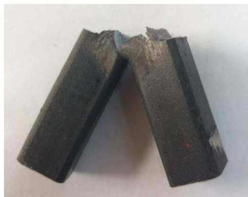
Fig. 8 Încercarea prin șoc a epruvetelor din E295
