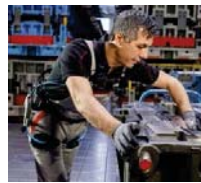
Fig. 3 Exoschelet pasiv pentru suportul trunchiului în timpul aplecării. [11]
