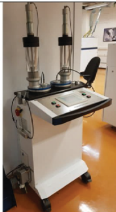
Fig. 8. Dispozitiv de livrare a pulberii
