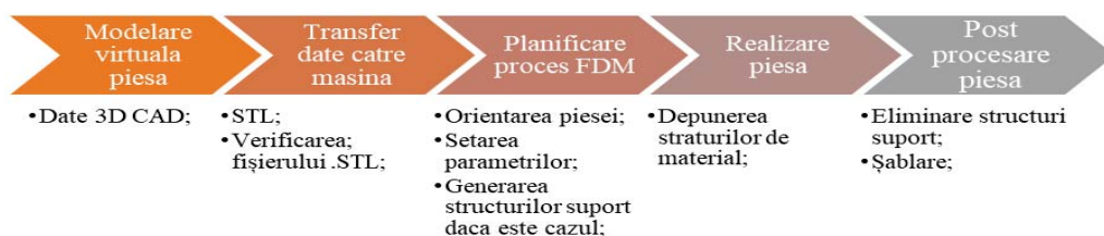
Fig. 5. Etapele procedurii de printare FDM
