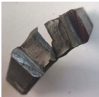
Fig. 8 Încercarea prin șoc a epruvetelor din E295
