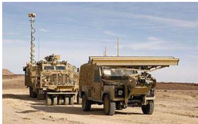
Fig. 4. Tanc Mastiff tractând vehiculul Panama care la rândul lui poartă un radar folosit pentru operațiile de eliberare a rutei [5]
