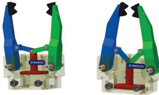
Fig. 16. Gripperul în fazele deschis și închis
