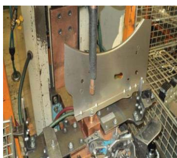
Fig. 3. Sudare 4 piulițe în plan Z
