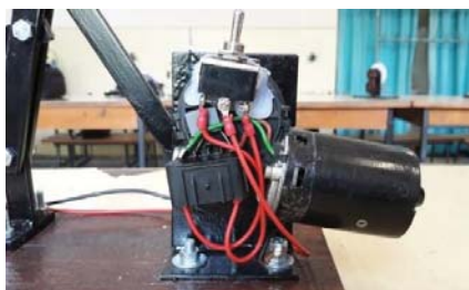
Fig. 10. Motorul de curent alternativ montat pe suportul de tablă
