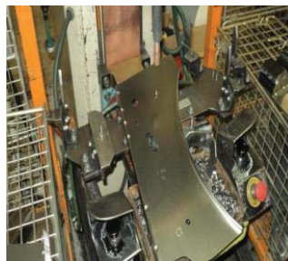
Fig. 4. Sudarea unei piulițe în plan Y
