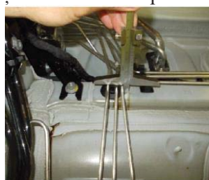
Fig.18. Dispozitiv de verificat al conductelor rigide
