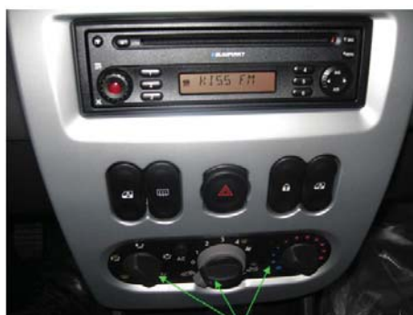
verificare climatizare rece-cald
