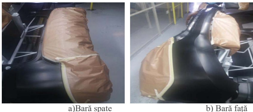
Fig. 1. Bare maruflete pregătite pentru vopsire pentru autovehiculul Duster
