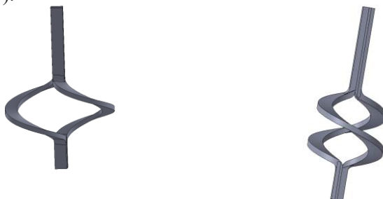
Fig. 7 . Model optimizat al protezei transtibiale pentru tenis
