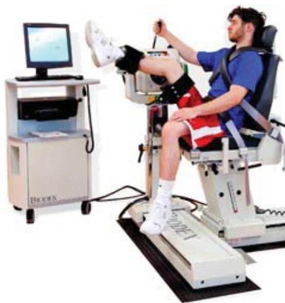
Fig. 2 Măsurarea cuplului forței genunchiului cu Sistemul Biodex Pro 3
