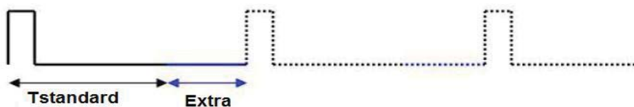
Fig. 4.3 Semnale provenite din PLC în prezența extraciclului
