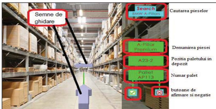
Fig 8.1 Aplicația AR pentru depozit.
