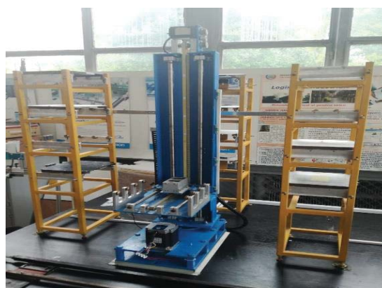
Fig. 2. Posturi pentru stocare intermediară și roboțarul Fig. 3. Sistemul de tip lift și rafturile de stocare
