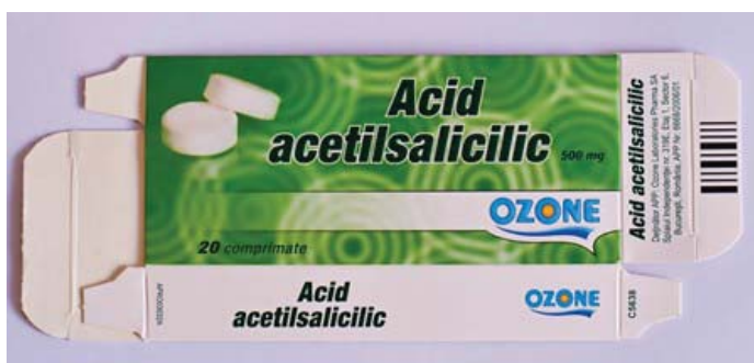
Fig. 6. Pliantul înainte de a fi preluat de mașina de ambalare secundară și înainte de a se introduce blisterele și prospectul
