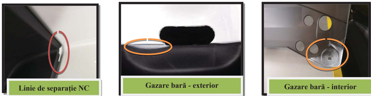
Fig.4. Defecte de calitate generate de maruflare necorespunzătoare
