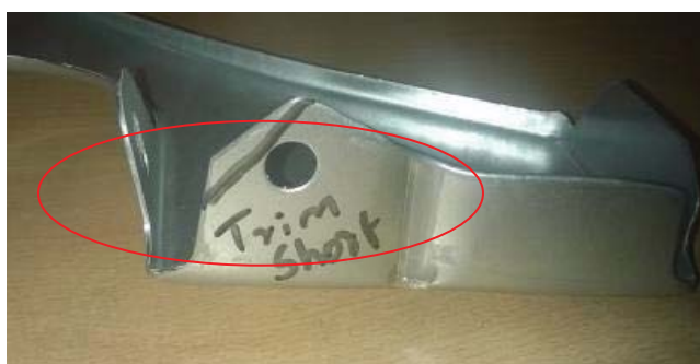
Fig. 7 - 676018195R ELEMENT LIAISON tip auto HJD(4x2)/(4x4)/BLK52 piesă reclamată de client
