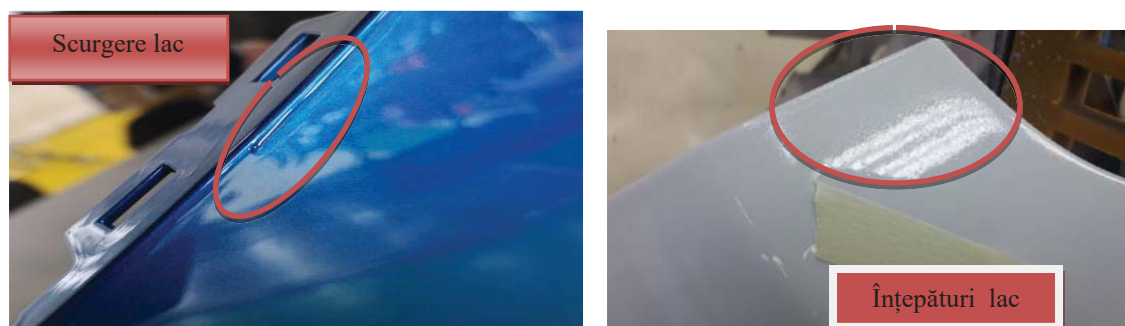
Fig.12. Defecte de calitate generate după aplicare Lac
