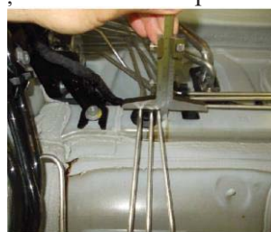
Fig.18. Dispozitiv de verificat al conductelor rigide
