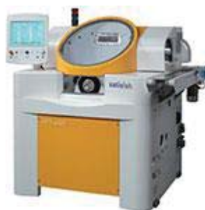
Figura 2. Generator de dioptrii- VFT orbit.
