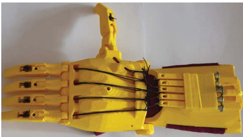
Fig. 1 Proteză de mână realizată prin procedul de extrudare de material după un model E-nable
