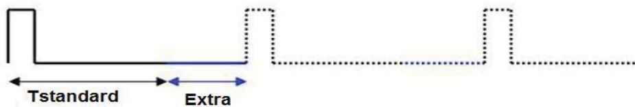
Fig. 4.3 Semnale provenite din PLC în prezența extraciclului
