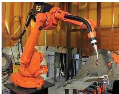
Fig.4. Robot industrial echipat pentru aplicatii de sudare [3].
