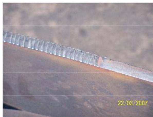
Figura 3.3 Aspectul suprafeței tăiate cu viteză mărită.
