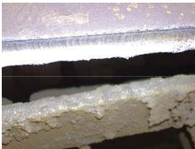
Figura 3.4 Aspectul suprafeței tăiate cu viteză scăzută.
