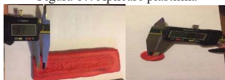
Figura 19. Măsurarea dimensiunilor neconformităților
