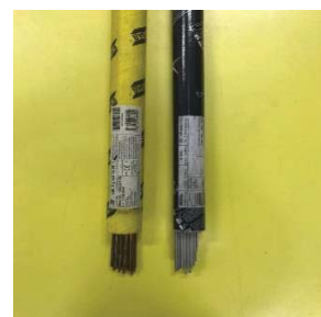
Figura 8. Mod de ambalare a vergelelor de WIG în cutii de carton
