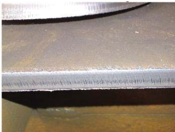
Figura 3.2. Aspectul suprafeței tăiate cu viteză prescrisă.
