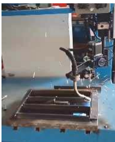
Fig. 5. Aplicație de sudare realizată de către MCN [4].
