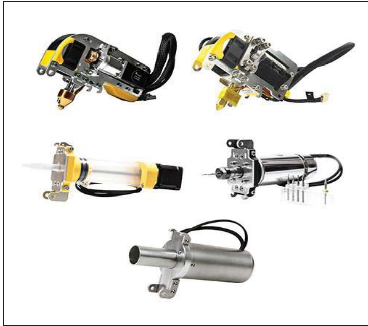
Fig.2. Capete interschimbabile ale ZMorph imprimantei hibride 3D
