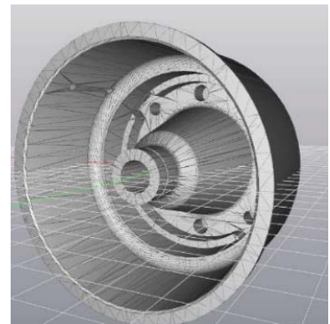
Figura 10. Mesh realizat din shell
