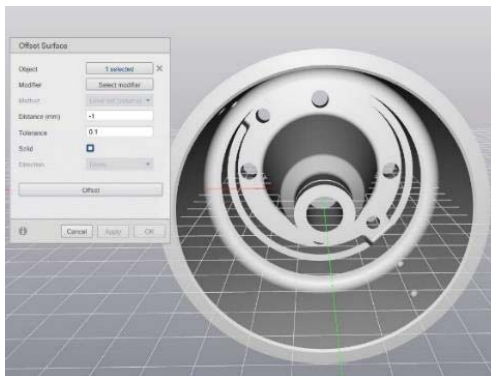
Figura 9. Se realizează un shell din modelul 3D
