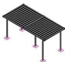
Fig. 7. Constrângeri de tip încastrare aplicate produsului
