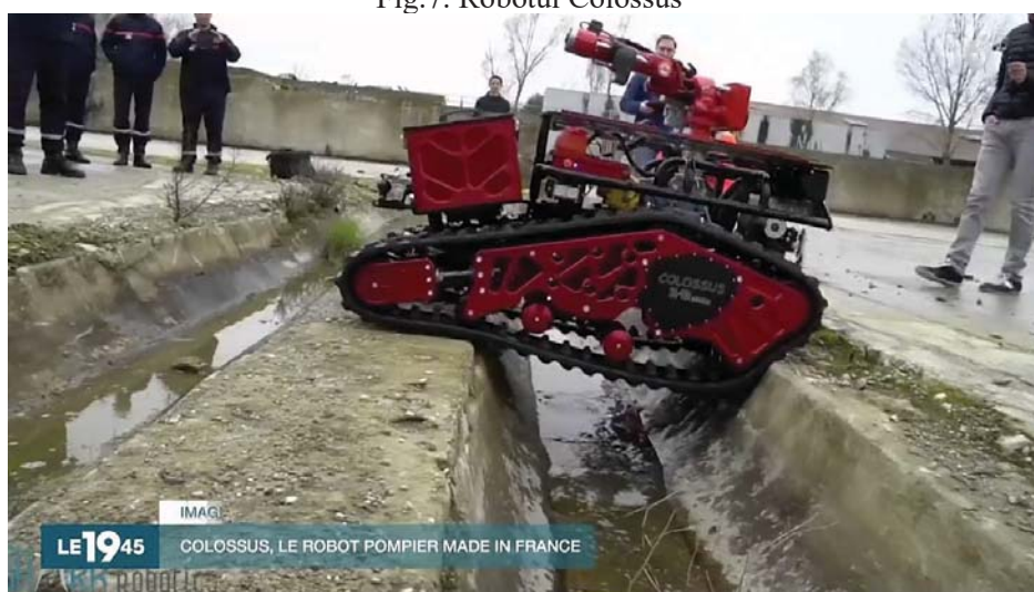
Fig.8. Robotul Colossus trecând peste obstacole precum rigole sau șanțuri
