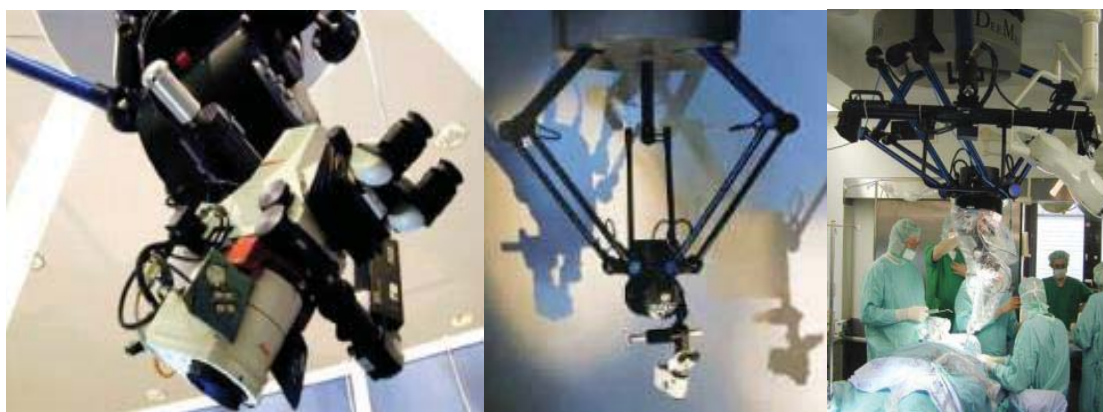
Fig.1. Surgiscope - robot paralel (tip DELTA) utilizat pentru poziționarea de mare precizie a instrumentelor în timpul operațiilor
