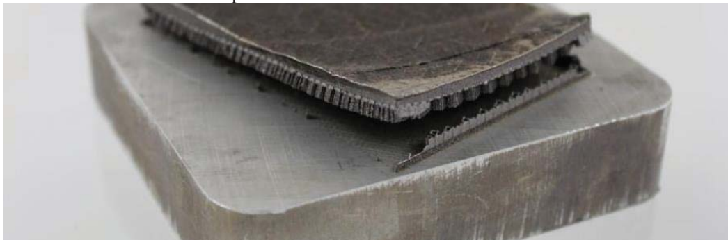
Fig. 5. Defect de desprindere a piesei în urma cedării suportilor
