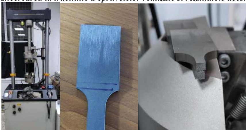
Fig. 11. Mașina de încercat la tracțiune, suprafața prinsă în bacuri a epruvetei încercate și suprafața ruptă
