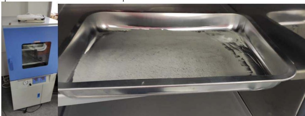
Fig. 8. Pregătirea pudrei metalice in vederea sinterizării
