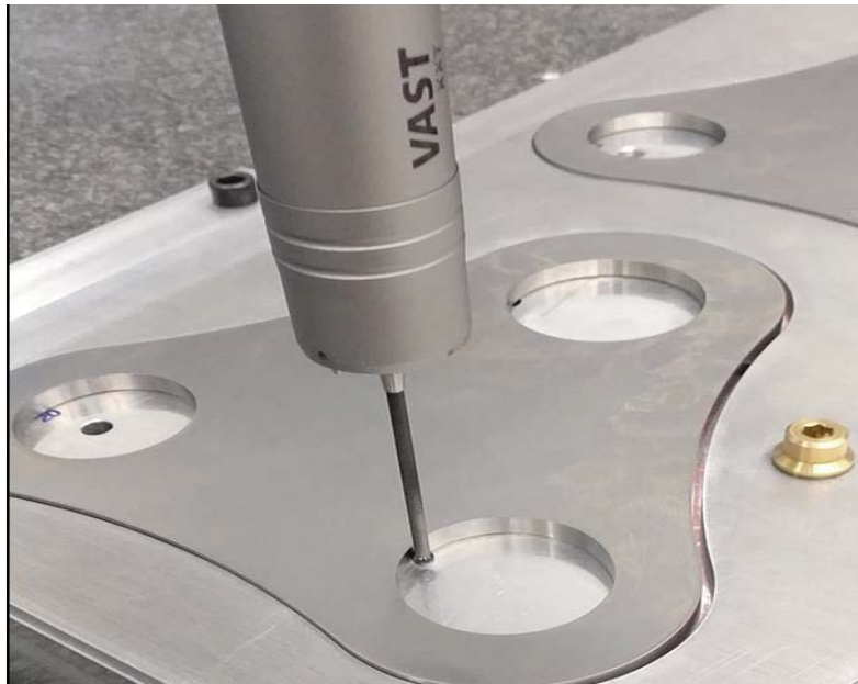
Figure 4. Mesure du diamètre et des concentricités en scannant Zeiss Accura II
