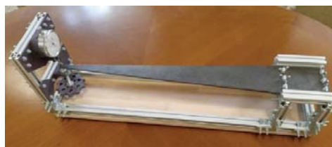
Fig.1 Grindă de egală rezistență la încovoiere
