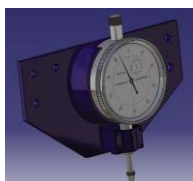
Fig.6 Sistemul de măsurare a săgeții
