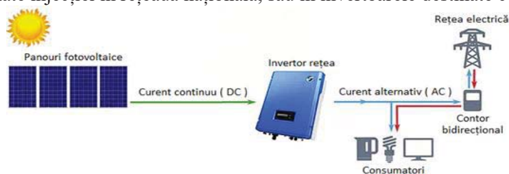
Fig. 1. Sistem fotovoltaic on grid cu livrare totală în SEN. [arhiva personală]
