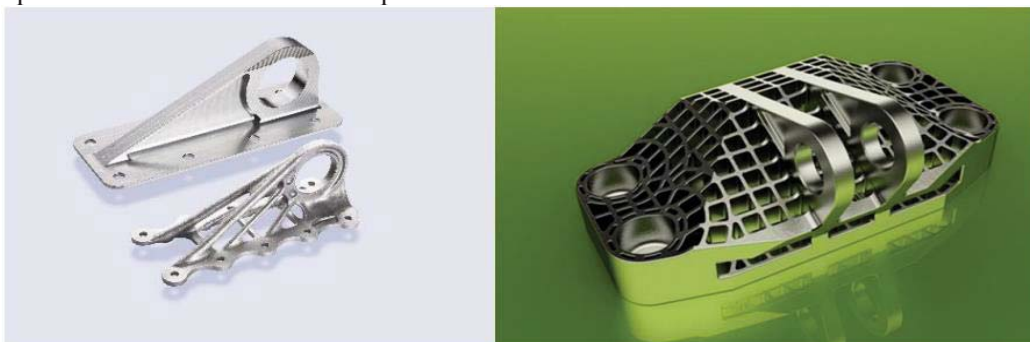
Fig. 3. Exemple de modele și piese realizate 3D prin sinterizare laser pe pulbere metalică
