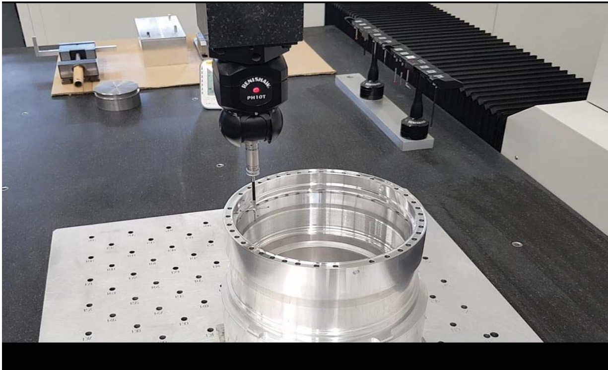
Fig. 2. Mesurer la pièce par palpation avec le palpeur étoile WENZEL XORBIT 87
