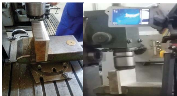
Fig.1. Prelucrarea prin frezare a piesei bimetalice
