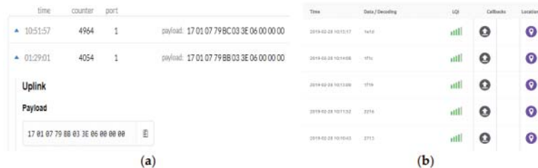
Fig. 7. Date digitale de la: (a) rețeaua LoRaWAN TTN; (b) rețeaua Sigfox [2]
