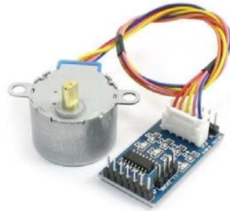
Fig. 9 Set Motor Pas cu Pas 28BYJ-48
