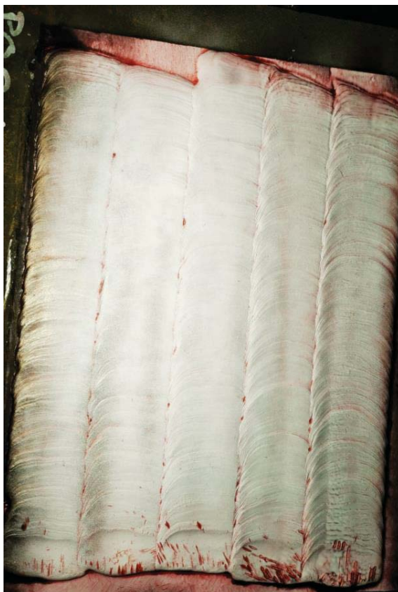
Figura 3. Examinare proba cu lichide penetrante
