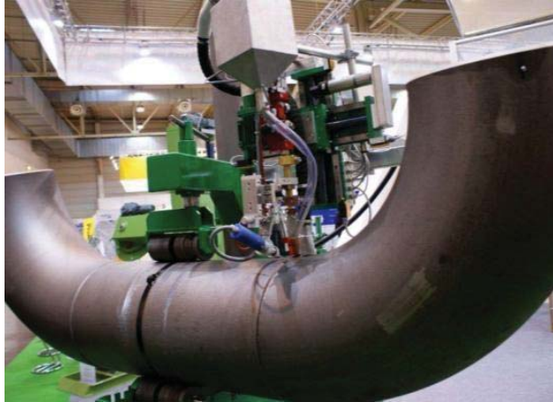
Fig. 1. Sudarea cu sursă termică fixă și componentă de sudare mobilă
