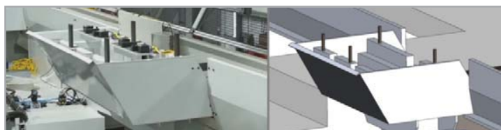
Fig. 7. Modelul real și modelul virtual al buffer-ului
