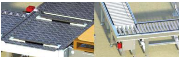
Fig. 23 Sistemele de liftare paleți/cutii pentru schimbarea direcției de mers
