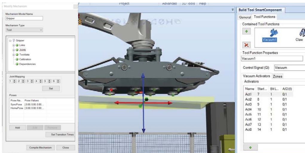
Fig. 31 Configurarea mecanismului și a funcțiilor efectorului (Vacuum x8 + Claw)
