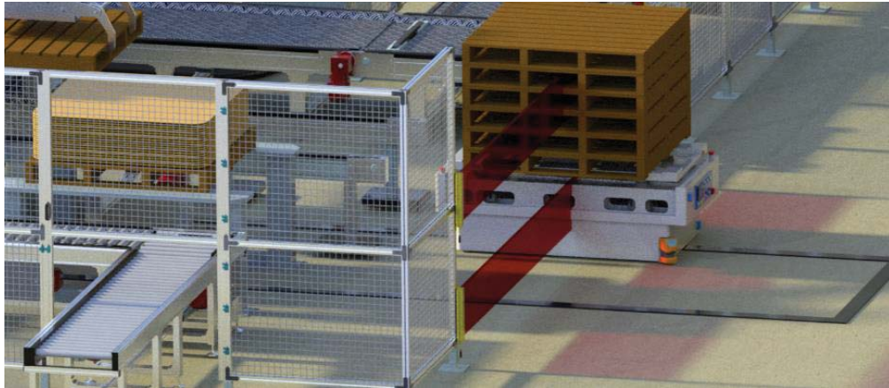
Fig 24. Bariere luminoase pentru protecție
