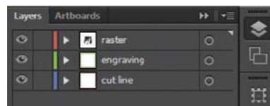
Fig. 8. Separarea operațiilor pe layere
