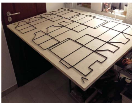
Fig. 3. Matriță folosită pentru ștanțarea plană
