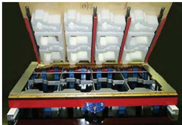
Fig. 5. Ansamblu de eliminare a cuiburilor
