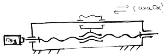
Fig. 17. Mecanism de mutare a carcaselor cu acumulatori
