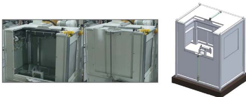
Fig. 8. Modelul real și modelul virtual al unității de spălare
