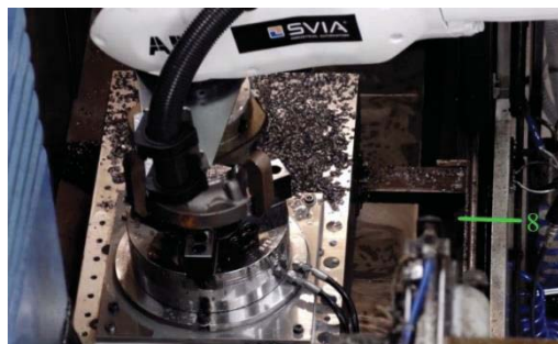
Fig.3 Descărcare piesă finită din centrul de frezare
