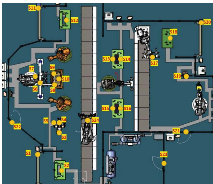
Fig. 2. Dispunerea senzorilor în celula robotizată
