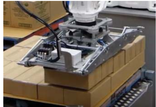
Fig 15. Efectorul cu bacurile retrase
