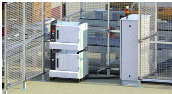
Fig 25. Cabinetul de control și dulapul electric al PLC-ului
