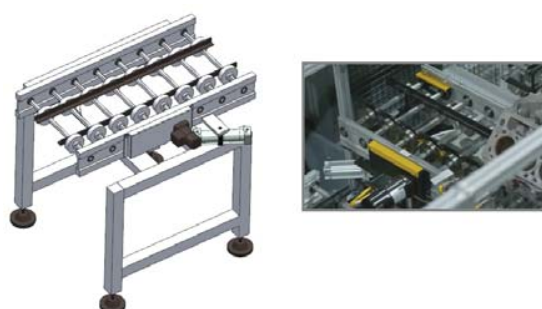
Fig. 9. Modelul real și modelul virtual al unității de spălare
