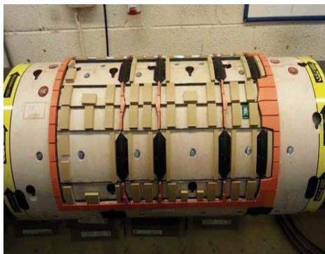
Fig. 2. Matriță reglabilă pentru ștanțarea rotativă
