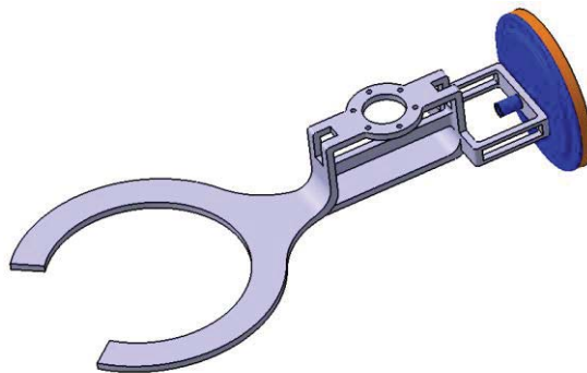
Figura 3. Efector de preluare și manipulare,
