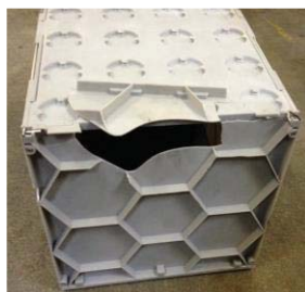
Fig.1. Cutie M-Box – proiect MODULUSCHA – cu defect [12]
