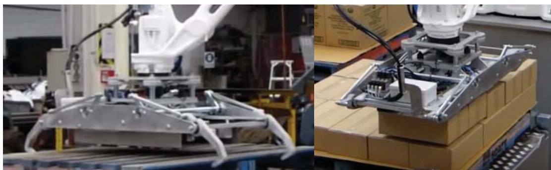
Fig. 4 Acționarea bacurilor efectorului
