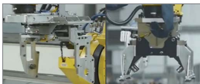
Fig. 10. Variantele de end-effector utilizate în cadrul aplicației
