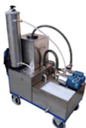
Fig 4. Dispozitiv pentru filtrare la găurirea EDM al companiei ELERO [5]
