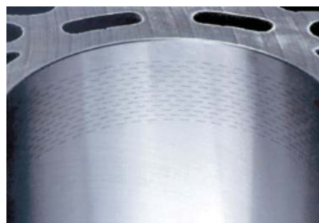
Fig. 3. Capul blocului motor după structurarea combinată [3]
