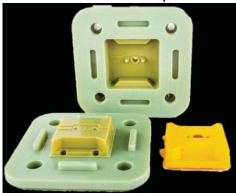
Fig. 2. – Varianta pentru matrițe interschimbabile compania Stratasys
