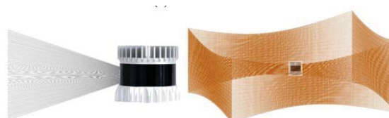
Fig. 2. Model de citire a unui LIDAR 3D la 360°
