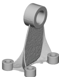
Fig. 16. Piesă din Inconel 718, Iterația 30
