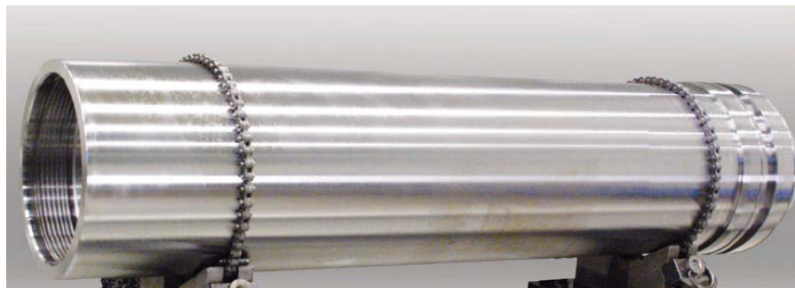
Fig. 12. Dispozitiv de orientare și fixare pentru honuirea interioară orizontală a unui cilindru [4]
