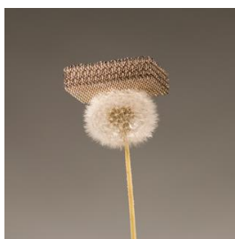
Fig. 1. Microtresa din nichel și fosfor susținută de o pădăie [10]
