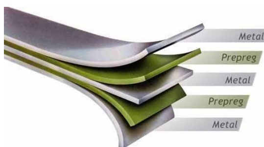
Figură 3 Fibre Metal Laminat Layup
