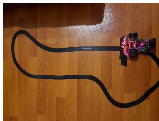
Fig. 9, 10. Model fizic asamblat (vedere frontală) și testarea senzorilor pe traseul de lucru
