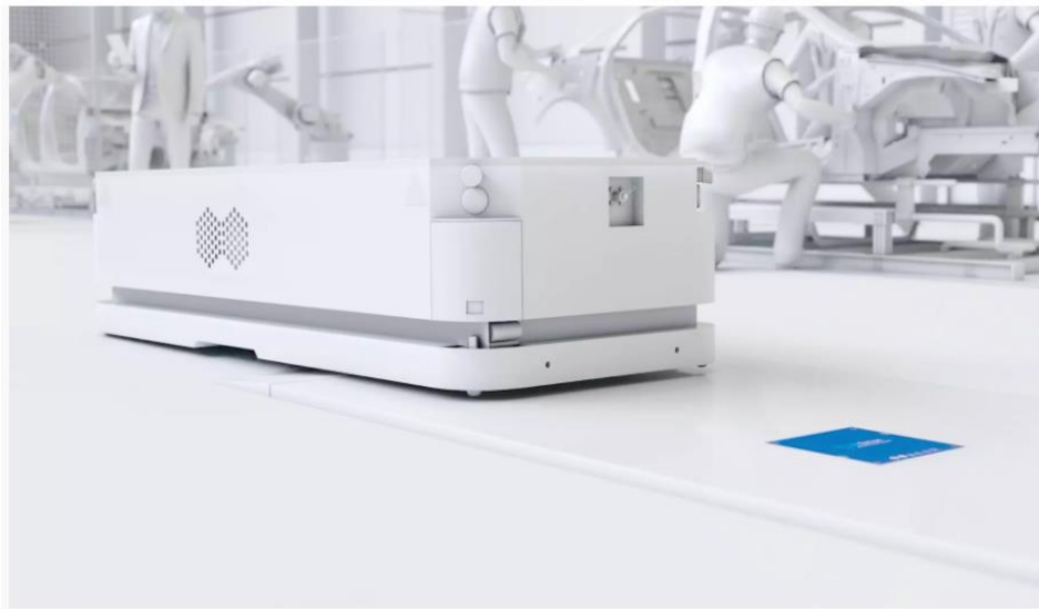
Fig.2. Vehicul ghidat automat (AGV)
