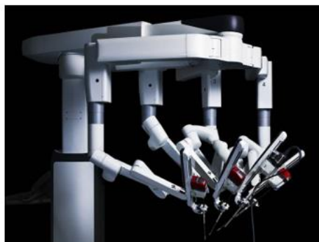
Fig. 8 Instrumentele avansate de care dispune sistemul Da Vinci
