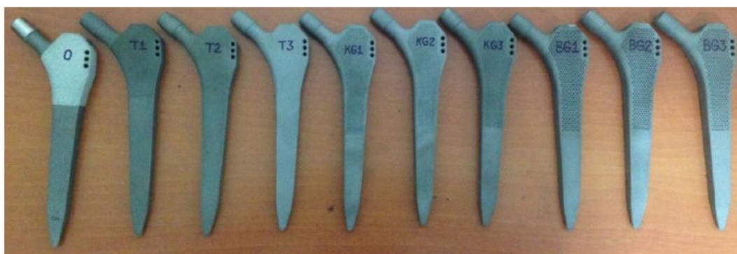
Fig.5. Toate tipurile de implanturi pregătite pentru testul la oboseală. [14]
