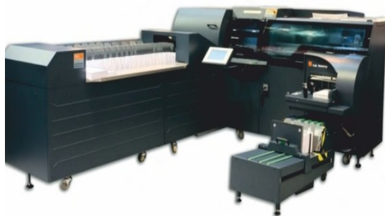
Fig. 5. Mașina de broșat BB 3102 EVA/PUR-C
