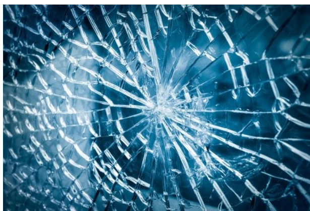
Fig. 9. Efectele impactului mecanic asupra sticlei securizate
