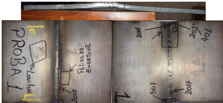
Fig. 7. Aspectul sudurii și identificarea imperfecțiunilor pentru Proba 1
