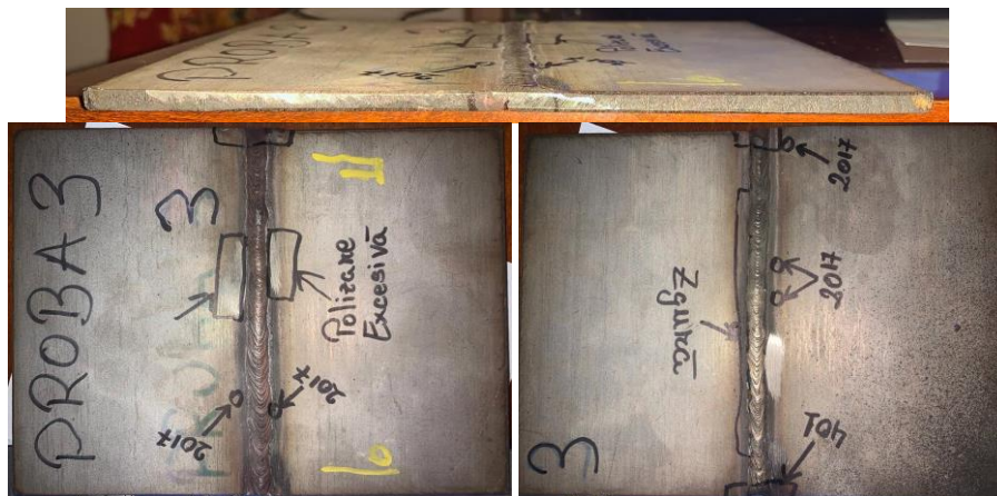
Fig. 9. Aspectul sudurii și identificarea imperfecțiunilor pentru Proba 3
