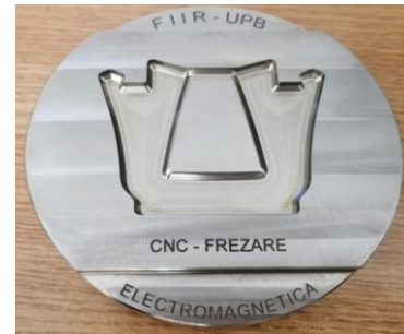
Fig. 2. Suprafața executată prin frezare
