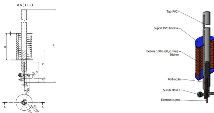
Fig. 3.3. Dimensionarea capului de lucru și părțile sa componente
