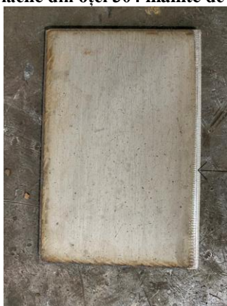
Fig. 3. Suprafața plăcii după degresarea cu etanol.
