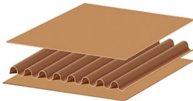
Fig. 1. Straturile cartonului ondulat [21]
