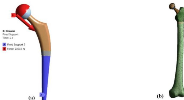
Fig.7. (a) Condițiile la limită aplicate implantului, (b) Modelul discretizat al implantului complet cu femurul
