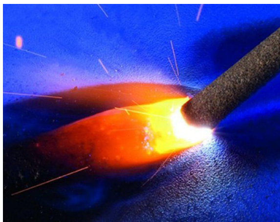
Fig. 2. Sudarea cu arc electric cu electrod învelit din Inox, proces 111
