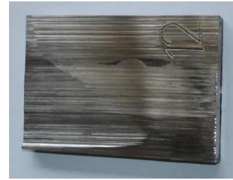
Fig. 2.0.2 Proba pregătită pentru testul de anduranță (a) și după uzare (b)
