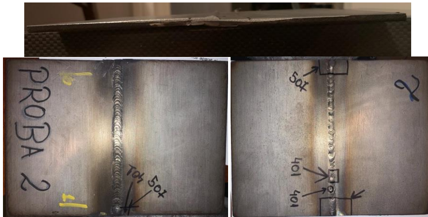
Fig. 8. Aspectul sudurii și identificarea imperfecțiunilor pentru Proba 2
