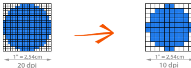
Fig. 2. Exemplificarea împărțirii punctelor per inch la o rezoluție de 20 dpi în comparație cu rezoluția de 10 dpi
